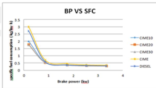
**FIG 2. BP v/s SFC diagram**
